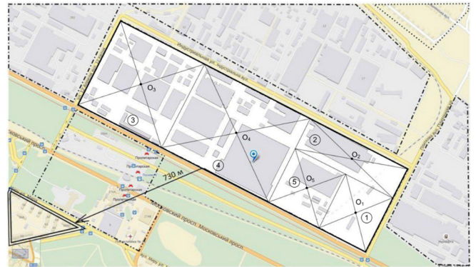
Рисунок 2. Нахождение геометрических центров технологических зон шумообразования для территории завода ЖБК № 15 в городе Харькове
