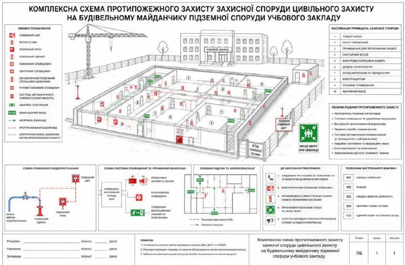
Рис. 4. Комплексна схема протипожежного захисту захисної споруди цивільного захисту
