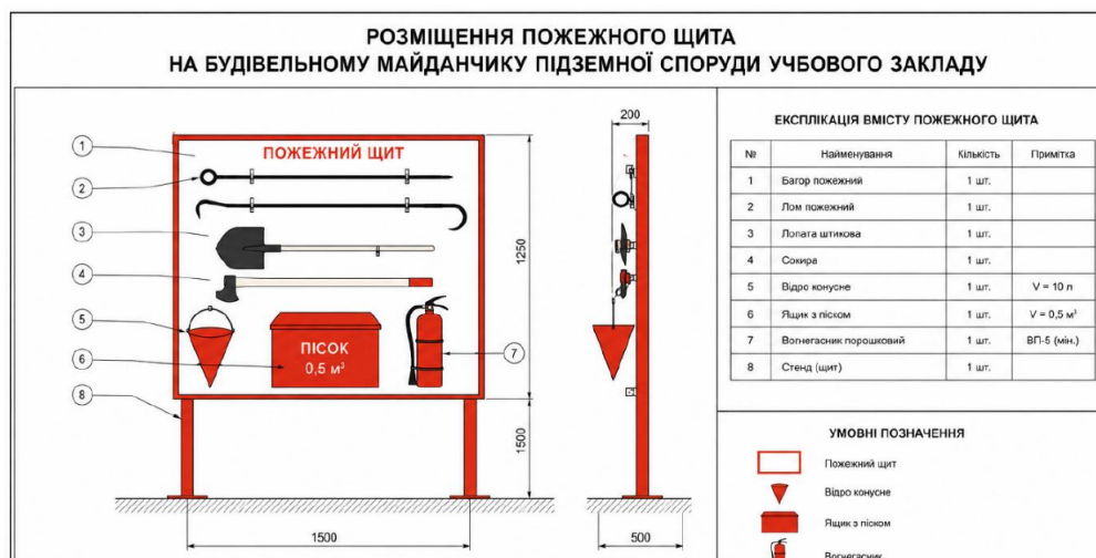
Рис. 2. Комплектація та розміщення пожежного щита
