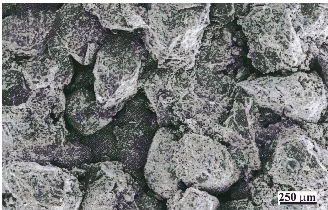
Рис. 7. СЕМ знімок зразка керна (регенерований кварц)
