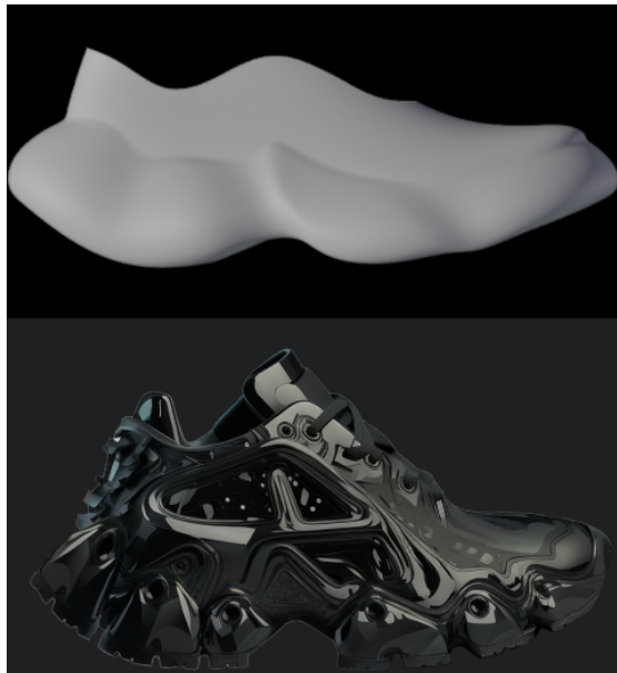
Рис. 4. Порівняння концепту і отриманої 3D-моделі після процесу адаптації до можливостей спрощеного моделювання
