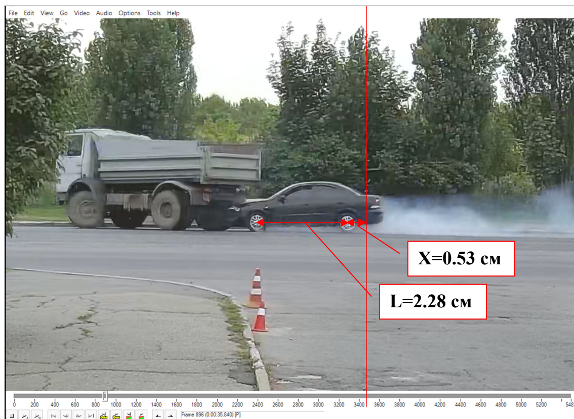
Рис. 5. Визначення швидкості руху автомобіля Nissan
