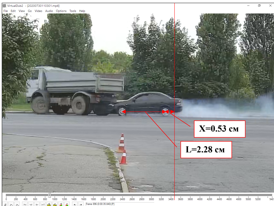
Рис. 5. Визначення швидкості руху автомобіля Nissan
