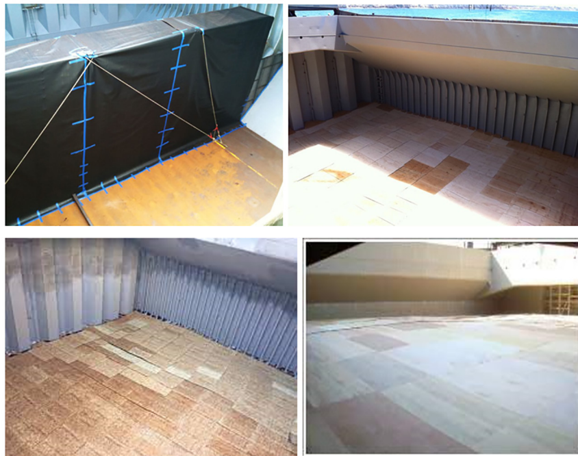
Рис. 3. Сепарація вантажів у трюмах судна
