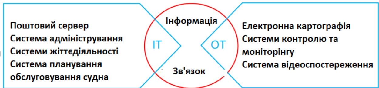
Рис. 1. Конвергенція інформаційних та операційних технологій [6]
