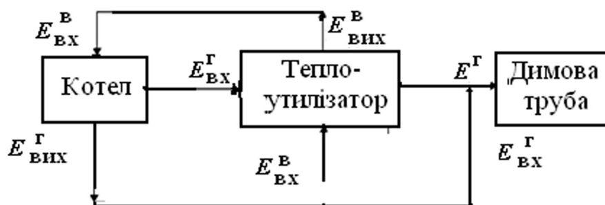
Рис. 1. Структурна схема котельної установки з теплоутилізатором при застосуванні методу байпасування димових газів для захисту газовідвідних трактів
