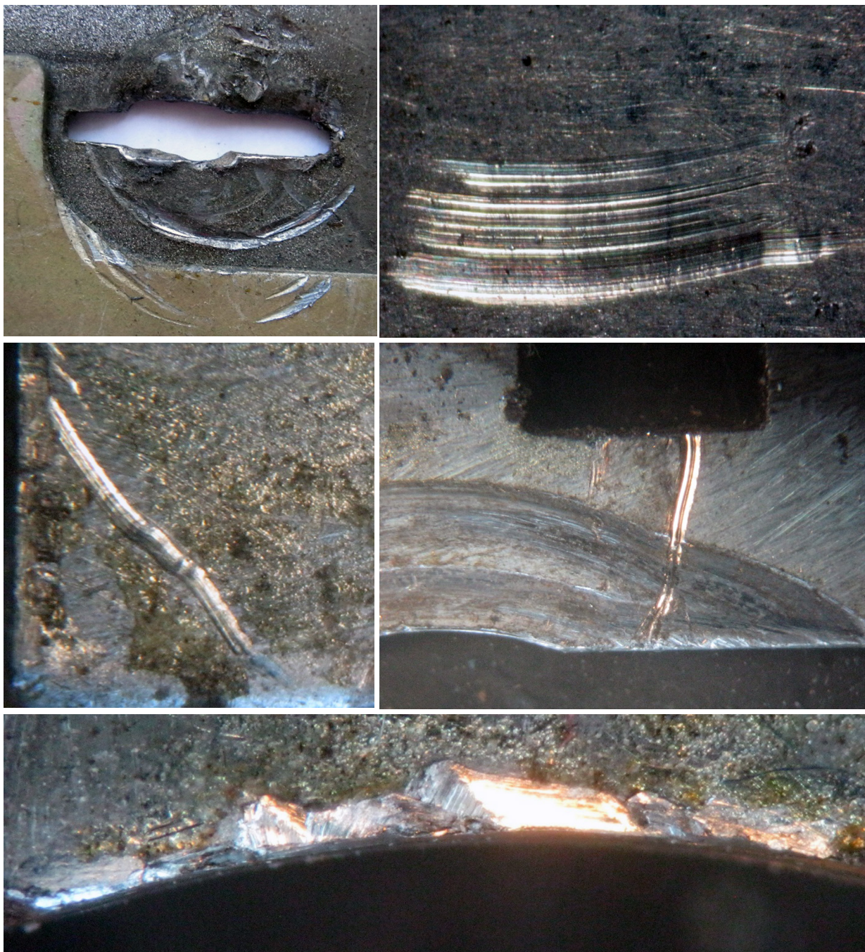
Рис. 5-9. Сліди від дії стороннього предмету на внутрішніх поверхнях врізного сувальдного замку, наданого на дослідження
