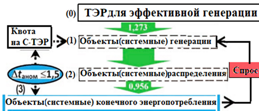
Рис. 1. Схема технологической цепи эффективных генерации, распределения и конечного потребления энергии с учетом ограничения (климатической квоты) на использование С-ТЭР и гранично допустимого отклонения \Delta t аномальной глобальной температуры от допустимого ее значения. Стрелки указывают основные потоки энергии (числа, Гт у.т. — плановые к 2030 году показатели ТЭР и конечной энергии потребления в соответствии с 4ЭП ЕС) и управляющей информации
