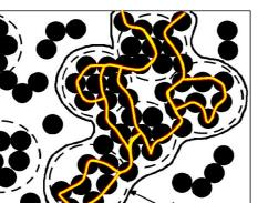
Рис. 1. Схема расположения в полимерной матрице частичек наполнителя при различных значениях ω: а) ниже первого порога перколяции; б), в) вблизи первого и второго порогов перколяции соответственно;
