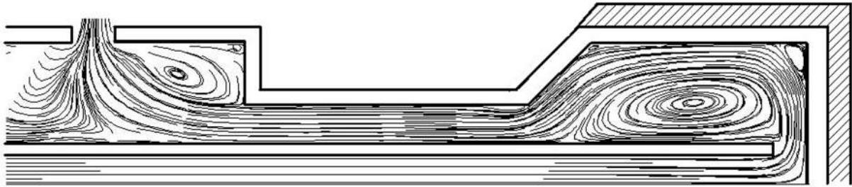
Рис. 2. Картина ліній течії газу в поздовжньому перерізі стабілізатора, що проходить через вісь газоподавальних отворів при обтіканні стабілізатора плоским імпульсним струменем
