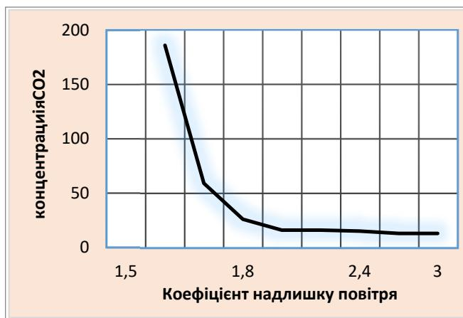
Рис. 4. Залежність концентрації CO<sub>2</sub> від коефіцієнту надлишку повітря
