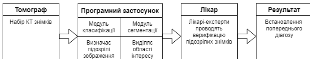
Рис. 1. Схема включення програмного застосунку в скринінг КТ знімків
