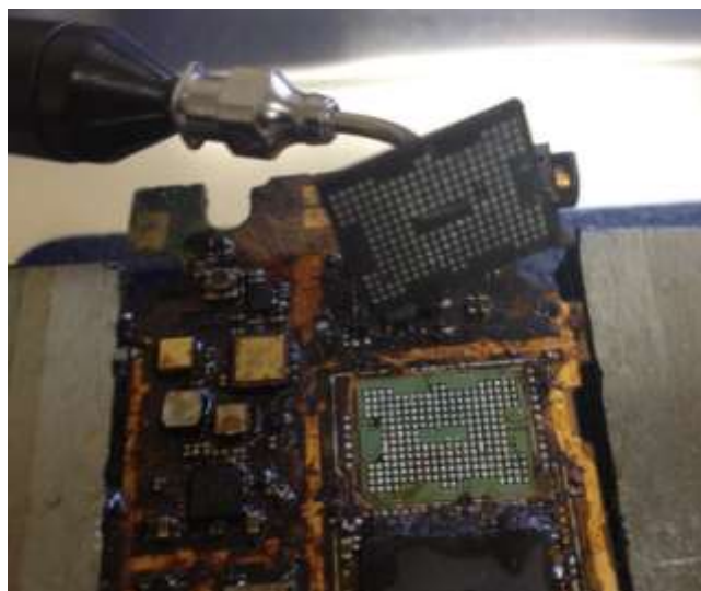
Ілюстрація 2. Випаяна мікросхема пам'яті з пошкодженого мобільного телефону
