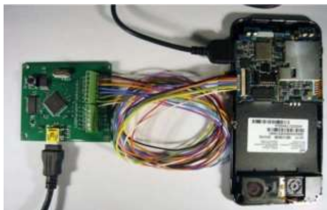
Ілюстрація 1. Підключення материнської мобільного телефону до програматора через JTAG інтерфейс
