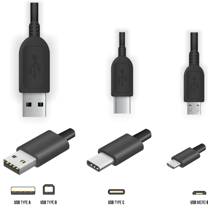
Рис. 1. Уніфікований інтерфейси підключення типу USB type A, USB type B, USB type C, USB micro B
