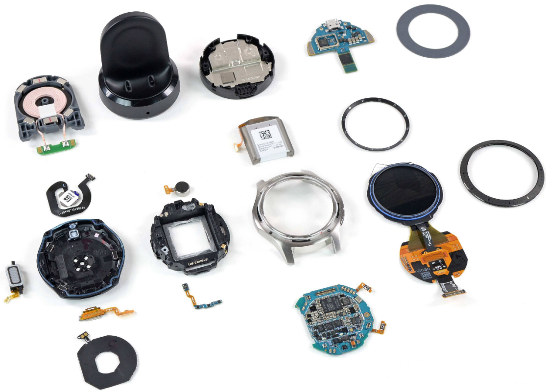
Рис. 2. Складові частини розібраного розумного годинника Samsung Gear S3
