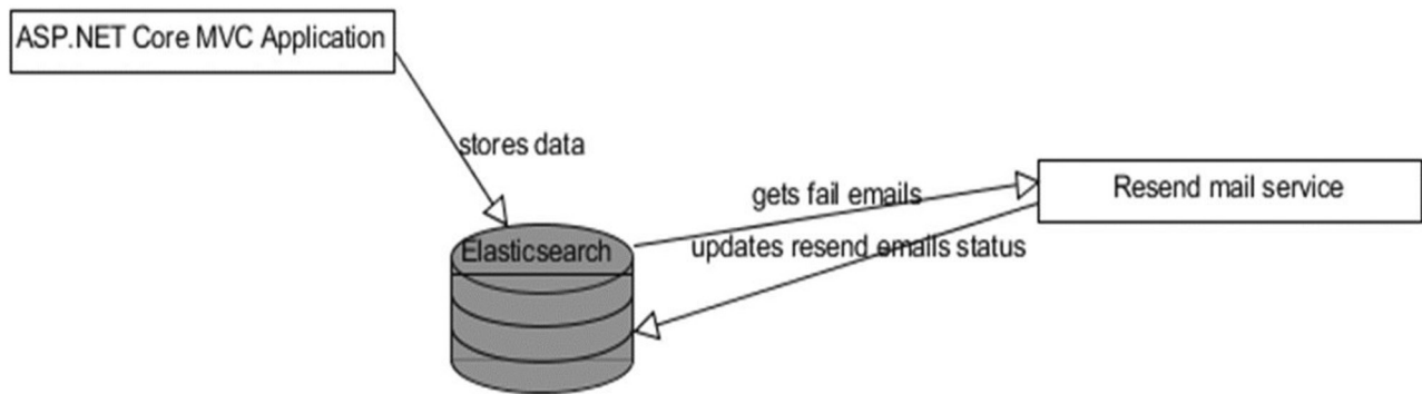
Рис. 2. Принцип роботи сервіса нотифікацій
