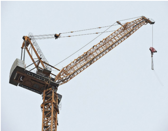
Рис. 5. Башенный кран с подъемной маховой стрелой
