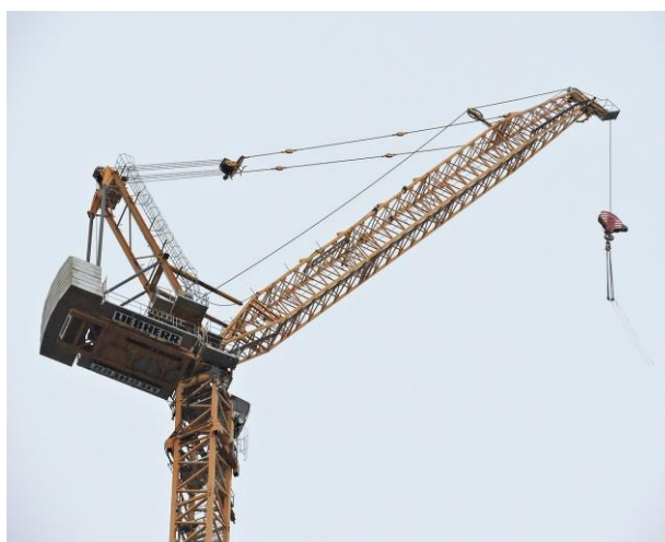
Рис. 5. Башенный кран с подъемной маховой стрелой
