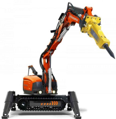
Рис. 4. Робот-разрушитель на гусеничном ходу
