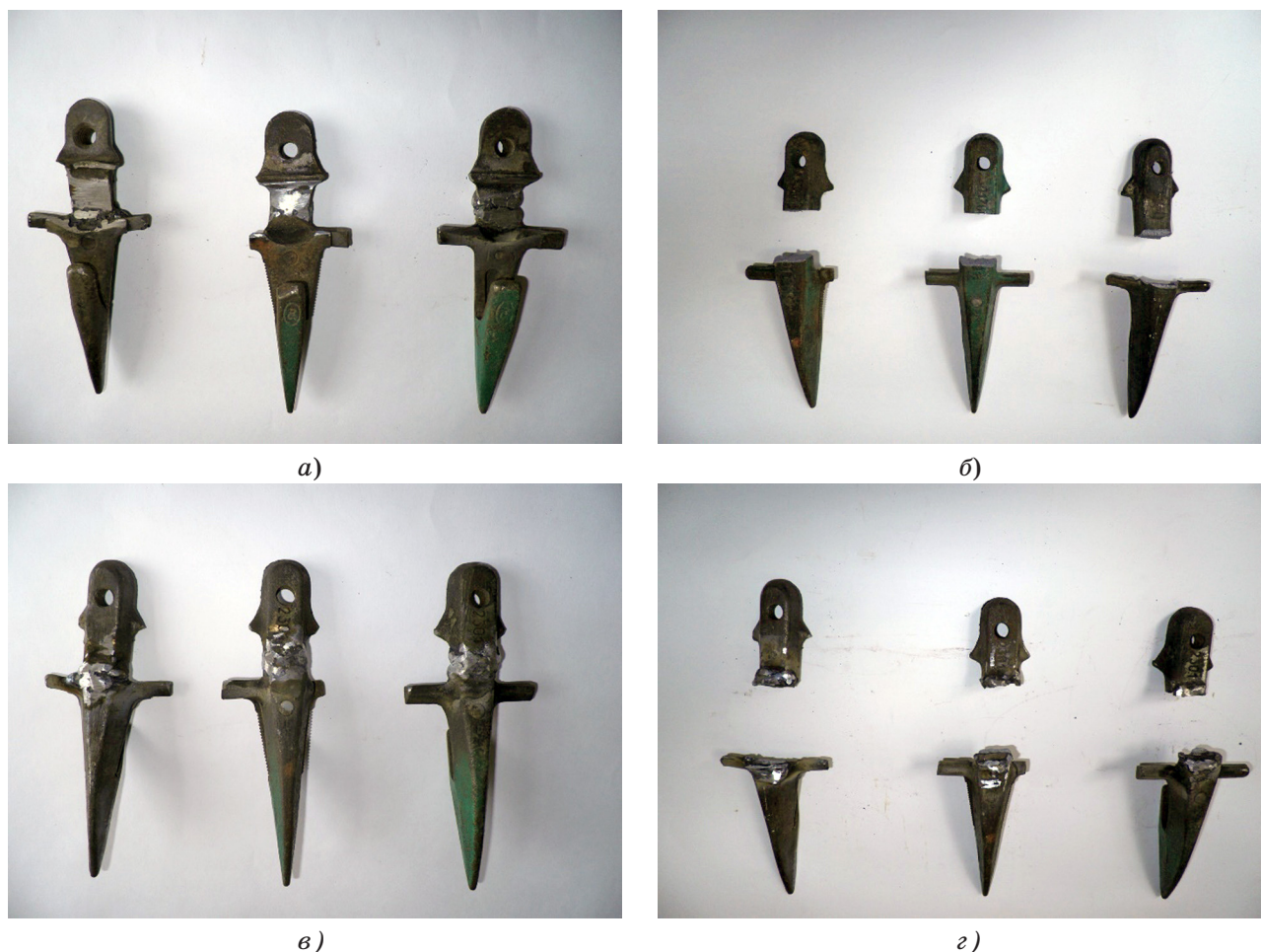
Рис. 5. Пальцы: а) целые, б) сломанные под прессом, в) сваренные сломанные части, г) повторно сломанные
