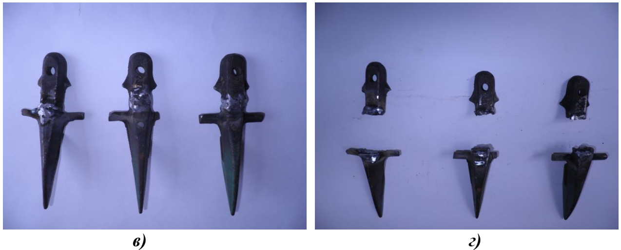
Рис. 5. Пальцы: а) целые, б) сломанные под прессом, в) сваренные сломанные части, г) повторно сломанные
