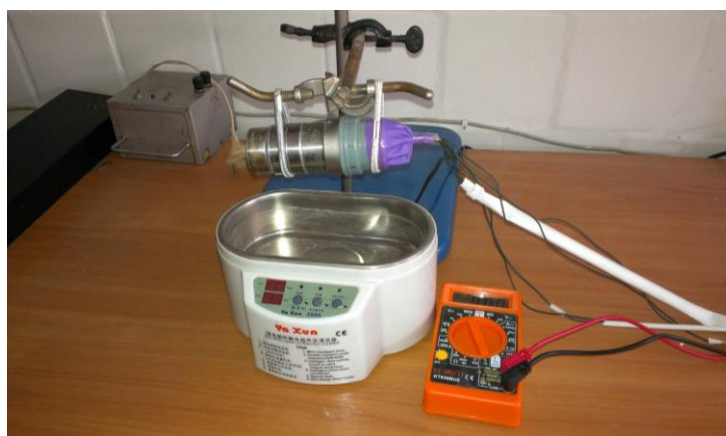
Рис. 2. Испытательный стенд: а) внешний вид; б) генератор плоской волны ультразвукового излучения
