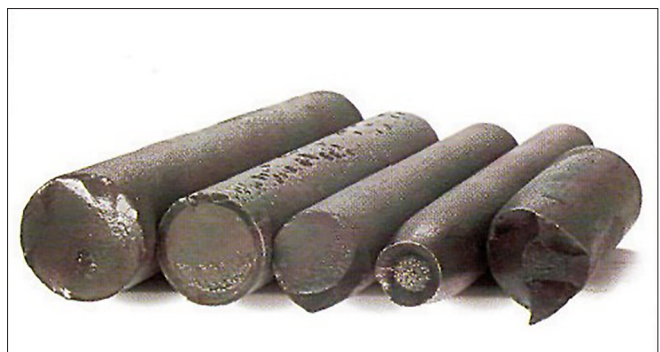
Рис. 1. Поломки від розтягу і втоми насосних штанг
