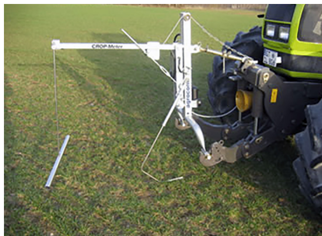
Рис. 13. Пристрій для визначення прогину стебел конструкції Олександра Броварця TSM 6.1
