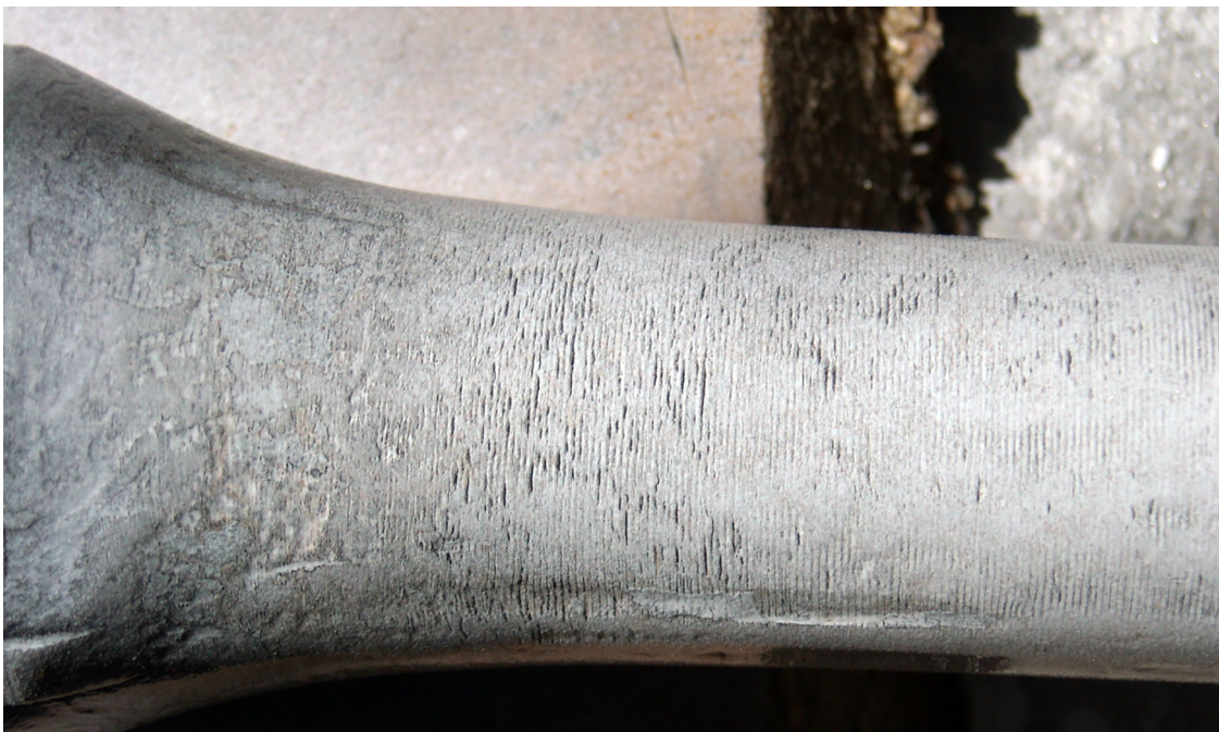
Рис. 4. Тріщини втомні, утворені в тілі штанг після випробувань при змінному напруженні \sigma=140 МПа
