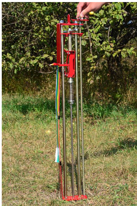
Рис. 9. Загальний вигляд автоматизованого твердоміра конструкції Олександра Броварця для оперативного моніторингу стану ґрунтового середовища із стаціонарним базуванням під час робочого процесу в ручному режимі
