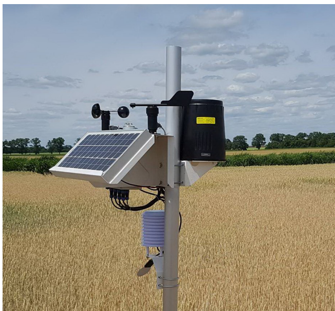
Рис. 12. Загальний вигляд метеостанції конструкції Олександра Броварця TSM 5.1 встановленої на полі у стаціонарному режимі
