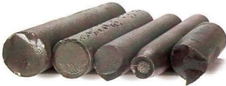
Рис. 1. Поломки від розтягу і втоми насосних штанг
