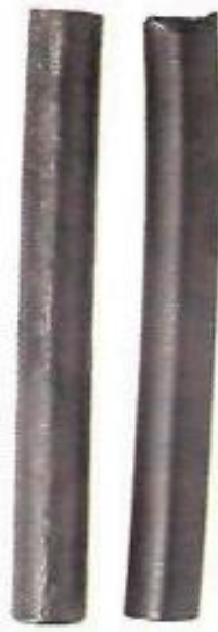
Рис. 3. Втомні поломки зігнутих штанг (вид з боку)
