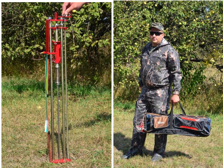
Рис. 9. Загальний вигляд автоматизованого твердоміра конструкції Олександра Броварця для оперативного моніторингу стану ґрунтового середовища із стаціонарним базуванням під час робочого процесу в ручному режимі
