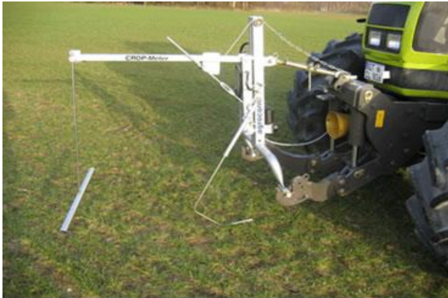
Рис. 13. Пристрій для визначення прогину стебел конструкції Олександра Броварця TSM 6.1
