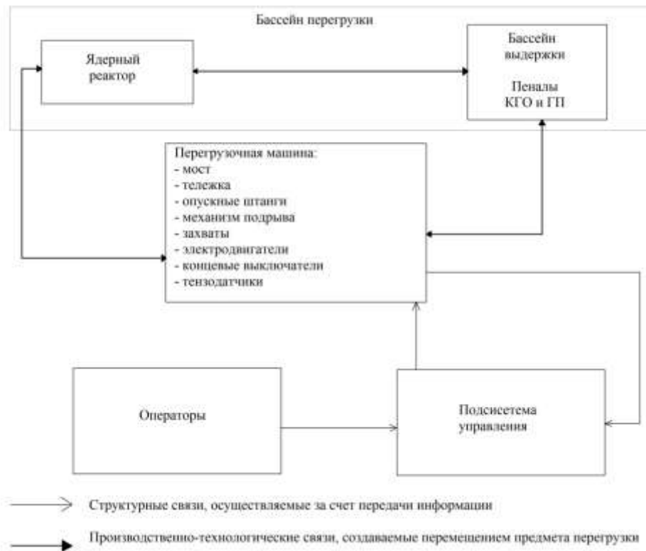
Рис. 3. Структура системы перегрузки ЯТ
