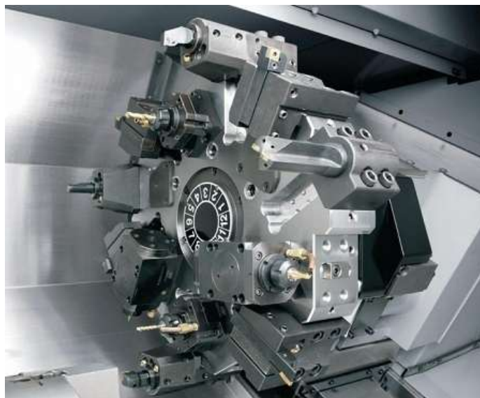
Рисунок 1. Револьверна головка токарного верстата з ЧПУ DMG MORI CL 2000 [5]
