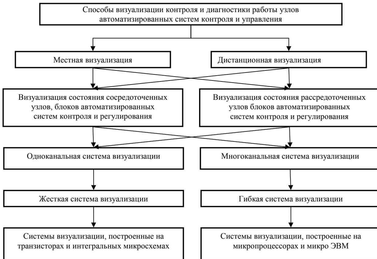
**Рис.3. Классификация систем визуализации состояния автоматизированных устройств систем контроля и регулирования параметров технологических процессов.**
