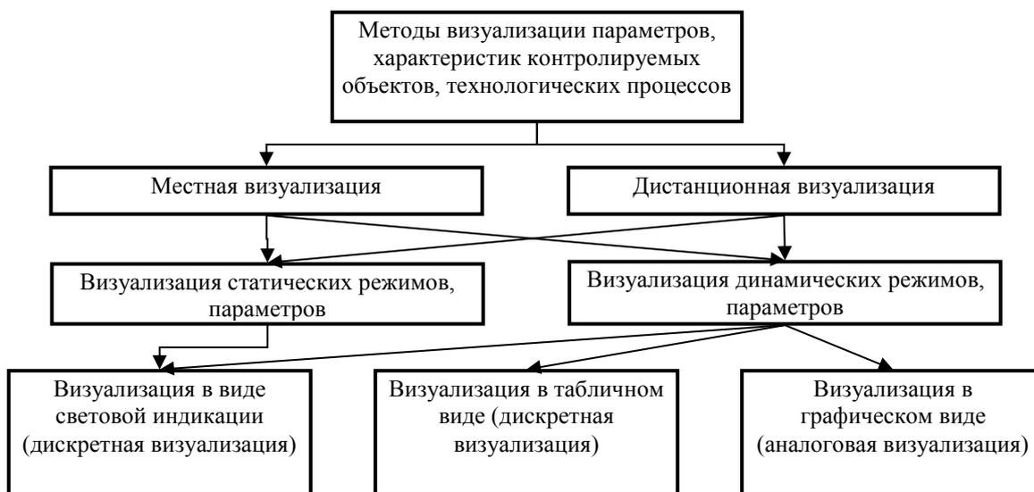
Рис.2. Классификация методов визуализации параметров контролируемых объектов.
