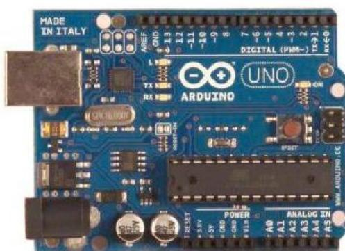
Рис.3. ArduinoUNO плата
