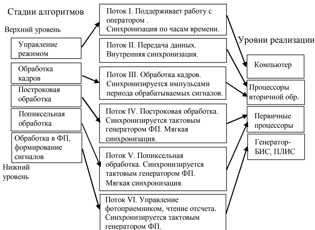
Рис. 2. Схема многоуровневых алгоритмов, потоков команд и их реализации [4, с.176].
