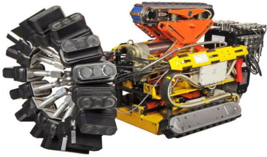
Рис.1.Робот для внутритрубного диагностирования
