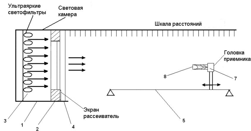
Рис.4 Функциональная схема установки физического моделирования энергетической освещенности:
