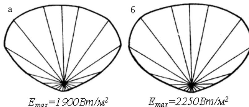
Рис.2 Диаграммы термического облучения на рабочих местах обжига
